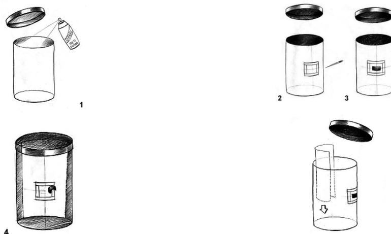
Figura 2: Construção da câmera pinhole
